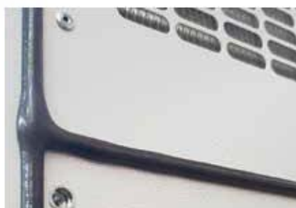
Guarnizione in poliuretano applicata in colata continua
