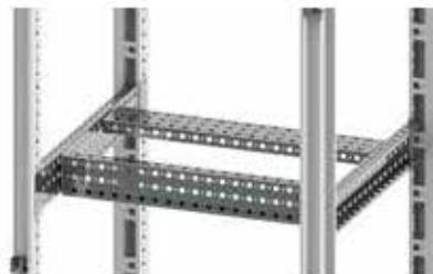
Profili in lamiera zincata sendzimir, installabili sul profilo portante dell'armadio. Consentono l'allestimento interno a passo regolabile (25 mm) e permettono di creare una struttura interna adattabile alle esigenze del cliente. Disponibili anche profili porta-trasformatore ed ancoraggio cavi.
