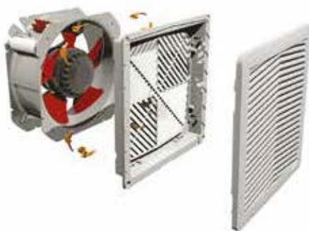
I ventilatori DKC possono essere utilizzati in tutti i casi in cui la temperatura ambiente (esterna armadio) risulti inferiore rispetto a quella interna al quadro elettronico. Composti da un gruppo ventilante e da una griglia con filtro per l'uscita dell'aria, filtrano l'aria che si immette nella parte inferiore dell'armadio, dissipando il calore e omogeneizzando la temperatura interna al quadro stesso.
