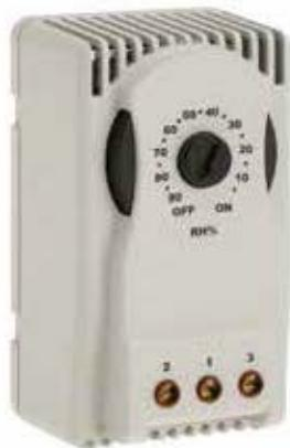
Permette il controllo costante dell'umidità all'interno dei quadri elettrici, attivando il riscaldatore anticondensa o il ventilatore al superamento di un valore preimpostato di umidità relativa dell'aria.
