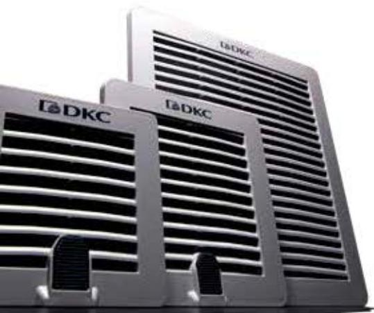
Montaggio del gruppo filtro ad incastro per mezzo di clip elastiche. In alternativa, possibilità di fissaggio a vite. Panno filtro previsto di serie e facilmente sostituibile rimuovendo la griglia frontale tramite l'apposito sistema, senza l'ausilio di utensili.
