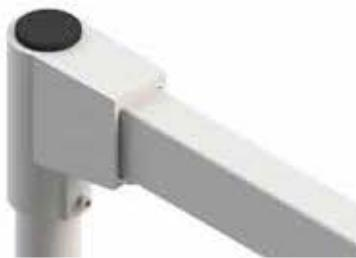
Per collegare l'elemento orizzontale con quello verticale del sistema braccio. Utilizzare in abbinamento al tubo rettangolare 60x40 mm (parte orizzontale) e al tubo circolare diam. 48 mm (parte verticale).
